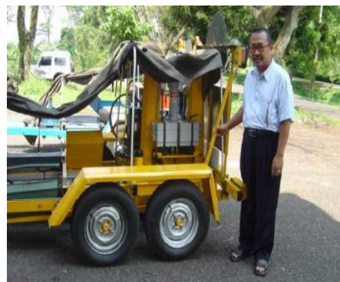
GAMBAR 3. Falling Weight Deflectometer jenis Dynatest 8000 yang digunakan dalam pengujian
