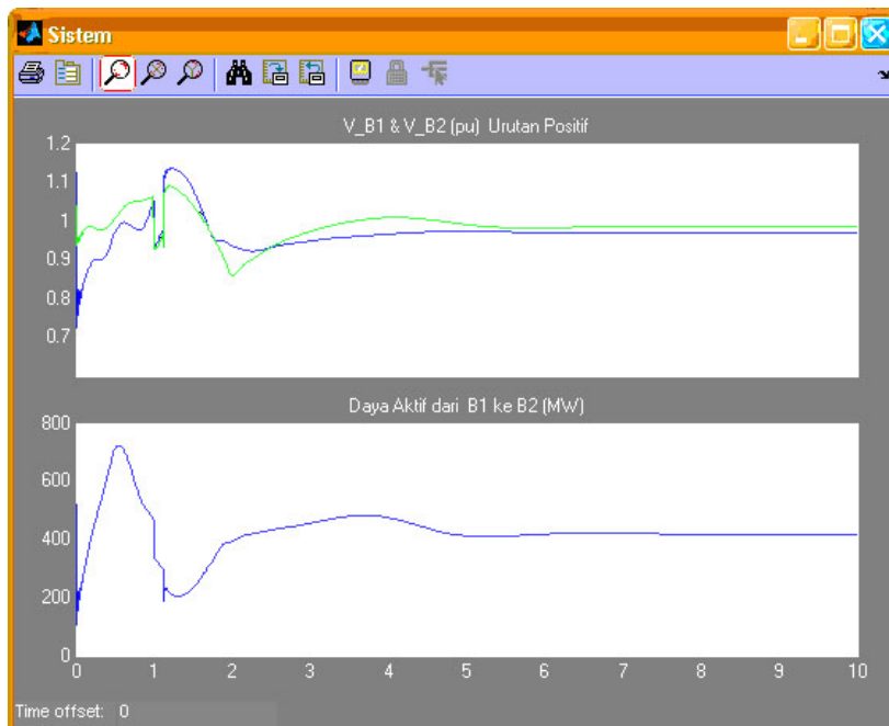
Gambar 7. Profil tegangan pada masing-masing bus dan aliran daya aktif pada saat gangguan fase ke tanah untuk kondisi dengan PSS neuro-fuzzy hasil rancangan.
