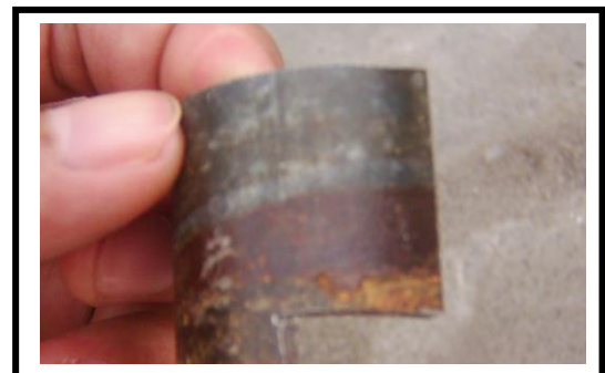
GAMBAR 5. Bentuk korosi pada permukaan luar nipple
