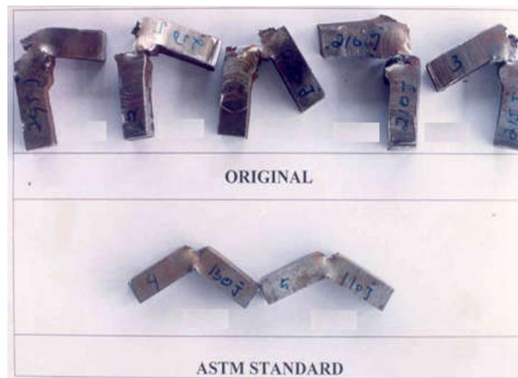
GAMBAR 8. Patahan hasil pengujian impak
