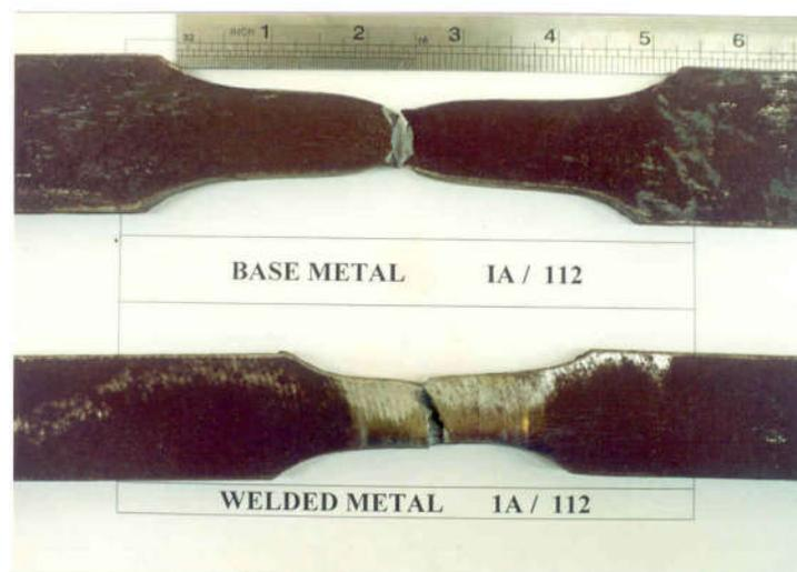
GAMBAR 6. Patahan Hasil pengujian tarik
