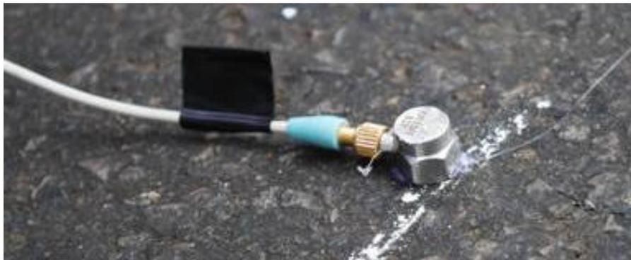
GAMBAR 1. Sensor akselerometer yang digunakan pada penelitian ini
