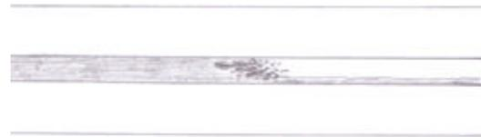
GAMBAR 24. Penggambaran gejala uap di dalam plug yang terkondensasi cepat pada pipa horizontal
