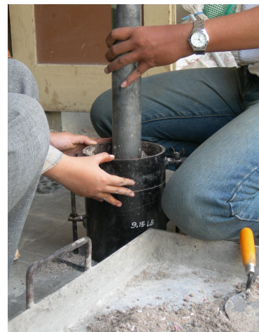
GAMBAR 2. Pembuatan benda uji
