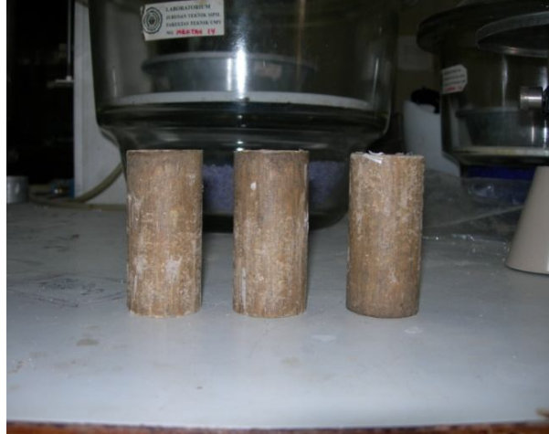
GAMBAR 3. Contoh benda uji untuk uji triaksial
