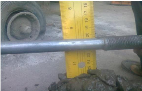
GAMBAR2. Pengujian Slump
